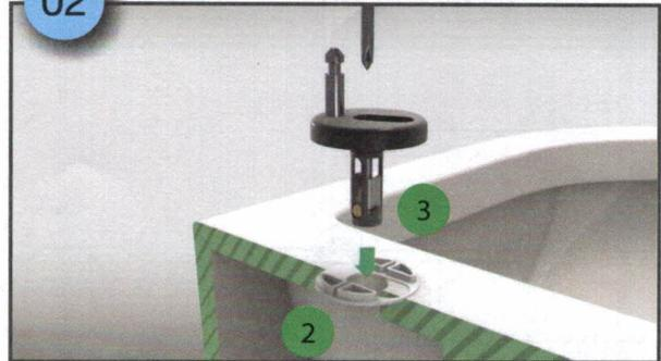
Befestigen Sie die Gummiunterlegscheibe (2) von unten auf der Nylonplatte (3).
