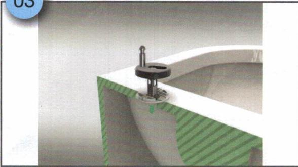
Führen Sie die Nylonplatte mit Dübel durch Öffnungen im WC .
