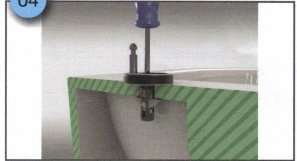
Verschrauben Sie die Einheit, bis der Kippdübel leicht angezogen ist.
