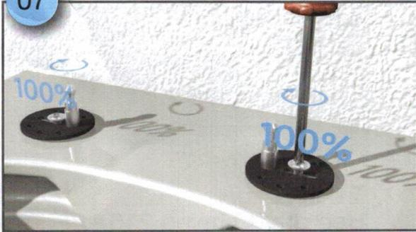
Verschrauben Sie nun die Nylonplatten (3), bis der Kippdübel fest angezogen ist.
